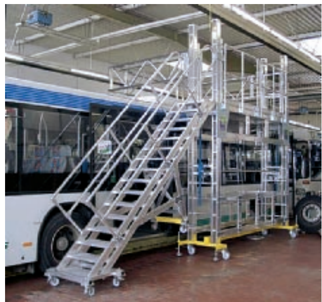
04.28622 Arbeitsbühne höhenverstellbar, mit ausschwenkb. Geländerring, Zustieg über Treppe, 8 Lenkrollen
