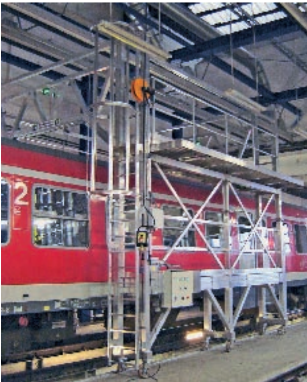
422741 Dacharbeitsbühne, elektr. verstellbar, Zustieg über integrierte Steigleiter, 12 Lenkrollen
