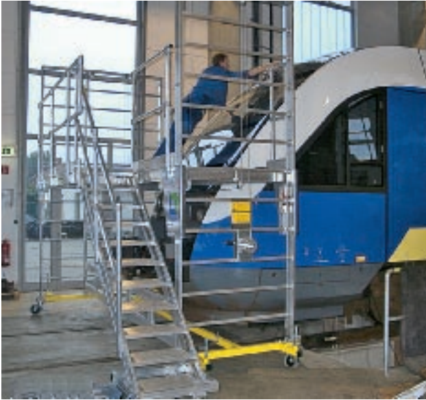
0416854 Stirnkopfbühne, mit Seilwinde höhenverstellbar, Zustieg über Treppe, 4 Lenkrollen
